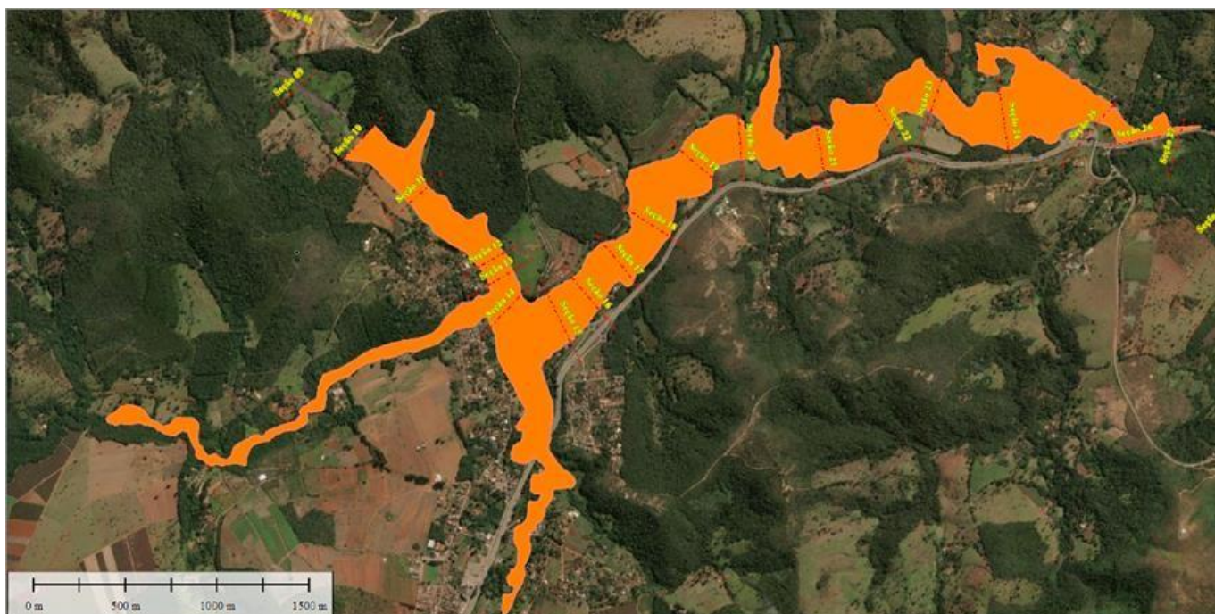
Seções de chegada da onda de inundação na área da ZAS a jusante da ECJ
