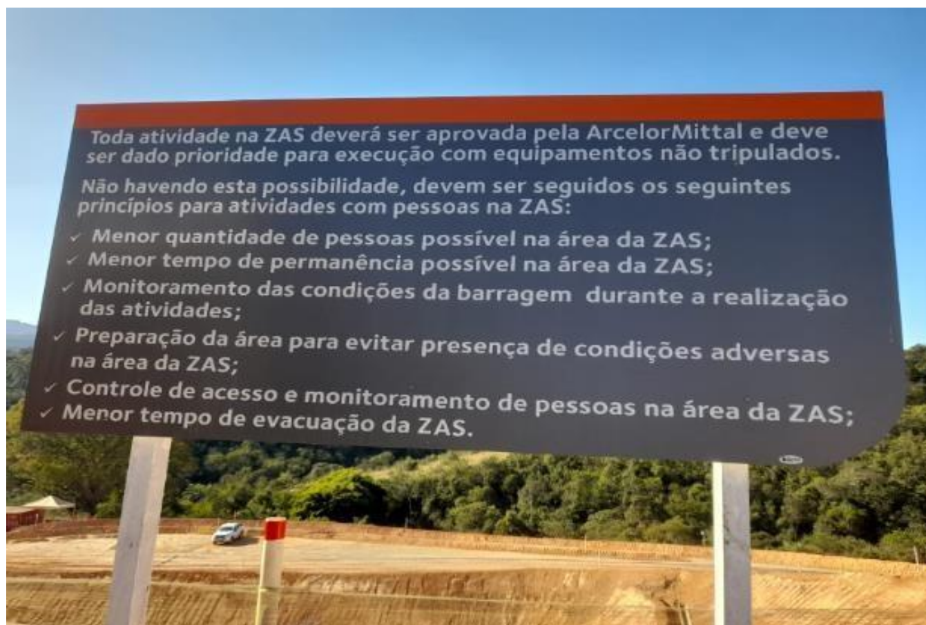
Placa de controle de acesso a ZAS
